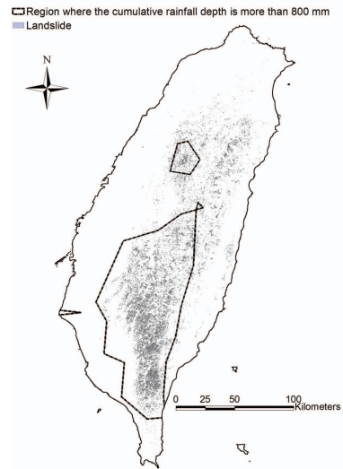
圖 3 莫拉克颱風期間崩塌地分佈圖
